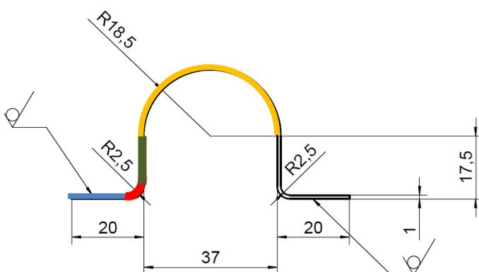
$$l_1 = 20\text{mm} - 1\text{mm} - 2,5\text{mm} = 16,5\text{mm}$$
