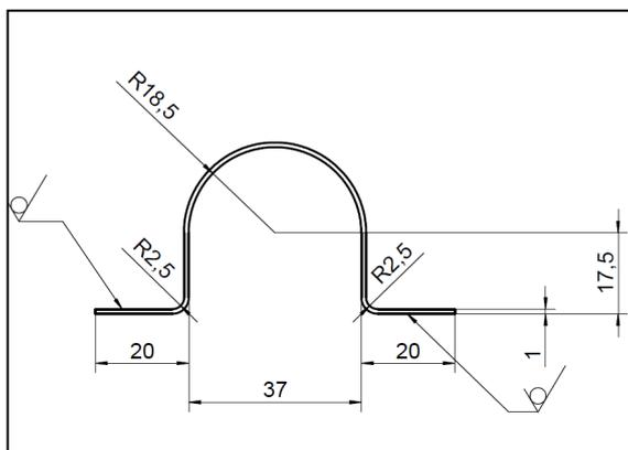
Bei der Rechnung wird daher auch der Radius bis zur neutralen Faser verwendet. Im vorliegenden Beispiel ist der Radius bei der Rechnung also Biegeradius plus die halbe Dicke vom Blech:
