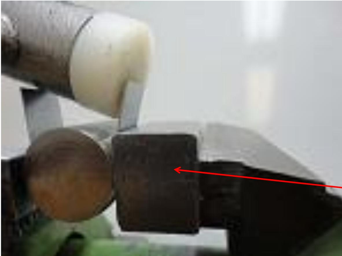
a) Spanne das Blech zum Biegen des ersten Lappens ein. Dabei sollte die Markierung bündig sein mit dem **quaderförmigen Biegeklötz**.
