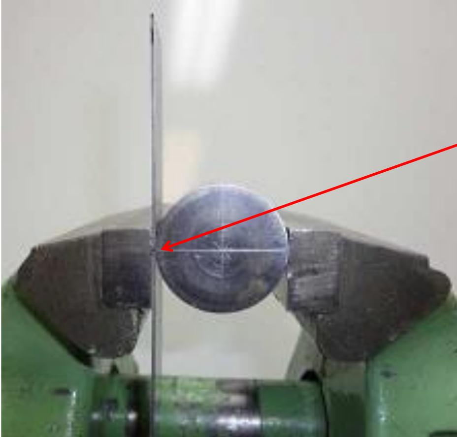
a) Spanne das Blech zum Biegen ein. Dabei sollen sowohl die **Markierung** in der **Mitte** des Blechs als auch in der **Mitte** des Biegeklotzes bündig sein mit der Kante des Schraubstocks und zwar entlang der ganzen Breite des Blechs!
