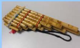
Resultat: Die Messung ergab eine durchschnittliche Schallgeschwindigkeit von  $c_{\text{Schall}} = 329 \text{ m/s}$ . Die Abweichung zum Literaturwert ( $c_{\text{Schall}} = 343,2 \text{ m/s}$  bei  $20^\circ\text{C}$ ) beträgt nur 5,8%.
